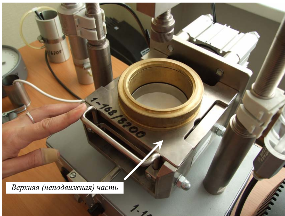
Рис. 8. Устанавливается неподвижная часть срезной коробки
