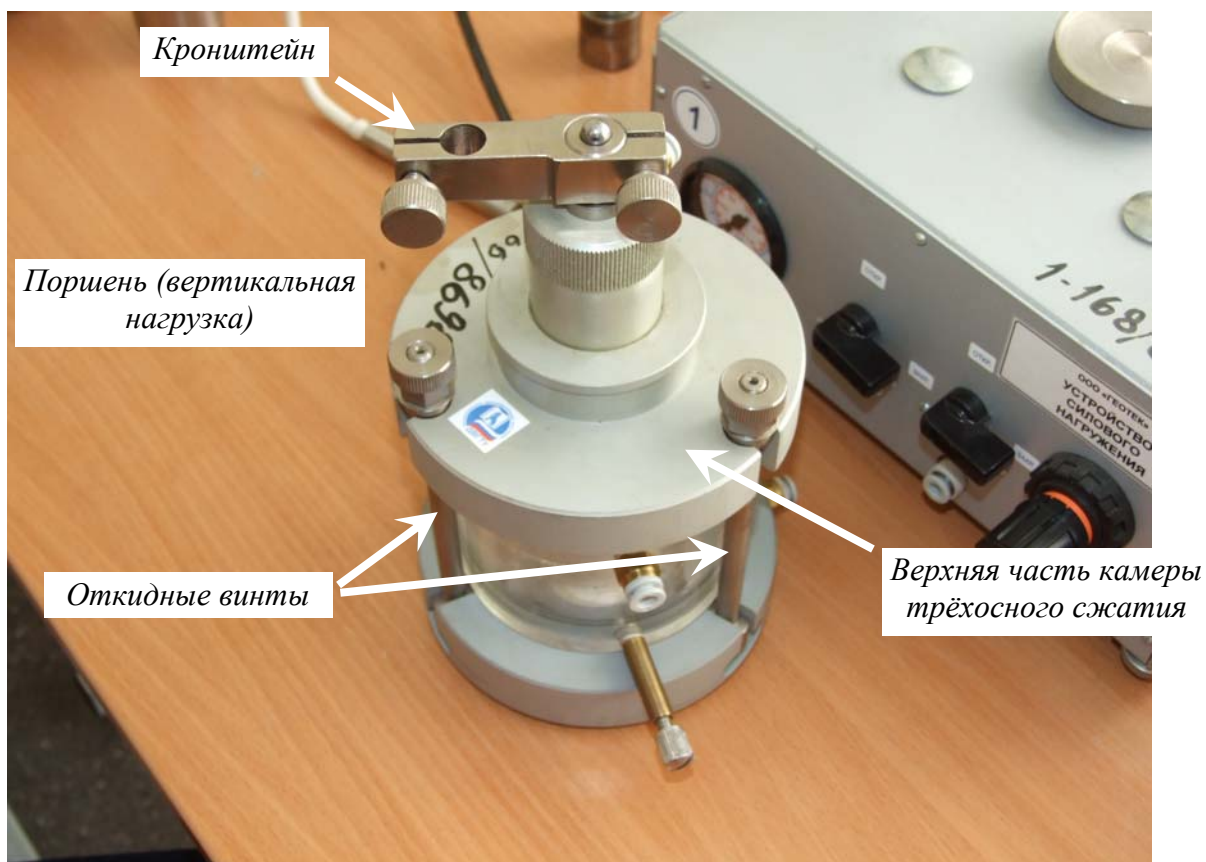
Рис 6. Установить верхнюю часть камеры трёхосного сжатия и закрепить её откидными винтами
