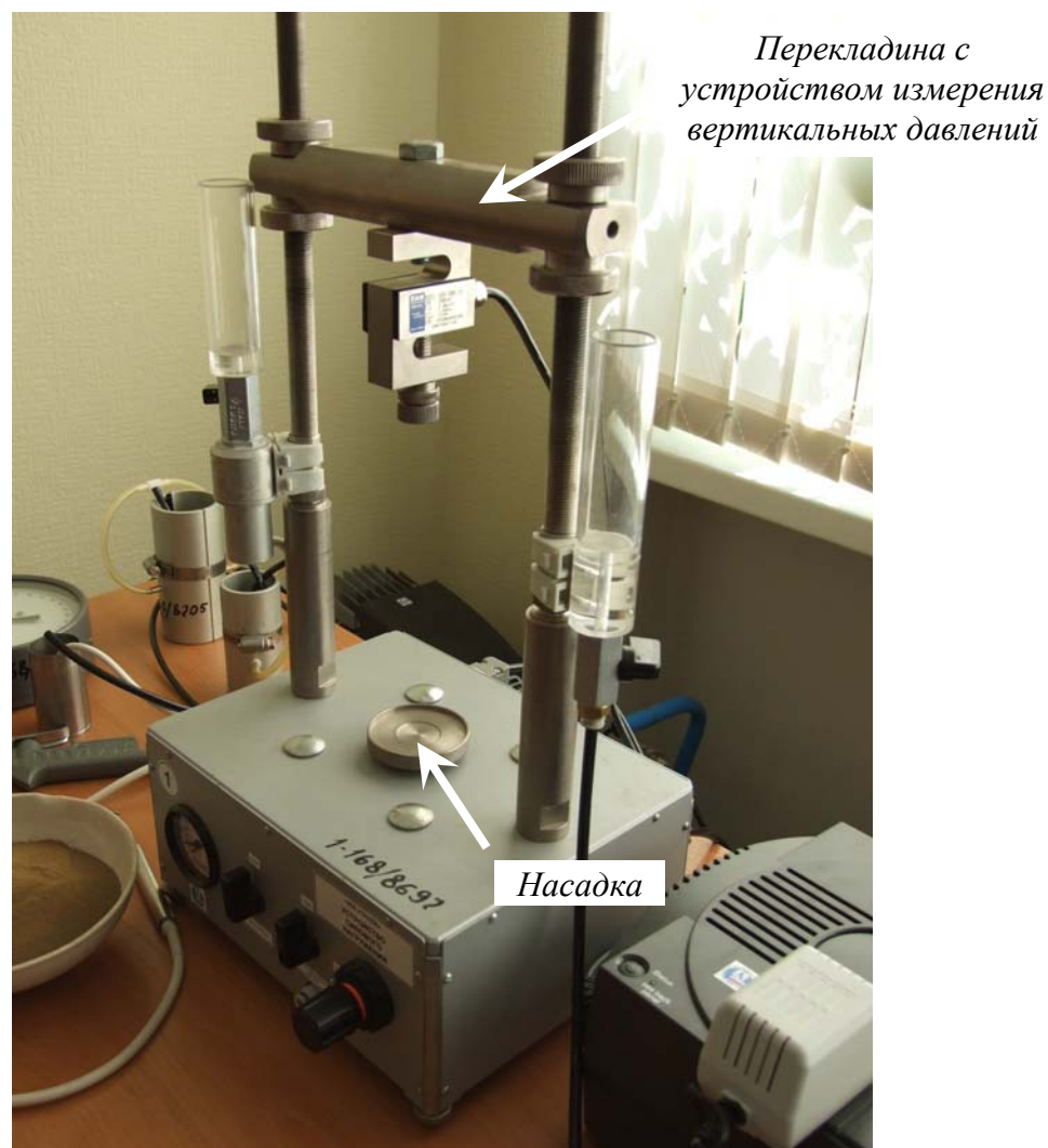
Рис. 1. Необходимо отрегулировать перекладину по высоте камеры стабилметра и установить насадку на устройство силового нагружения
