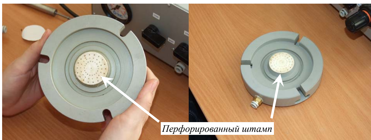
Рис. 2. На верхнюю и нижнюю части камеры трёхосного сжатия устанавливается перфорированный штамп
