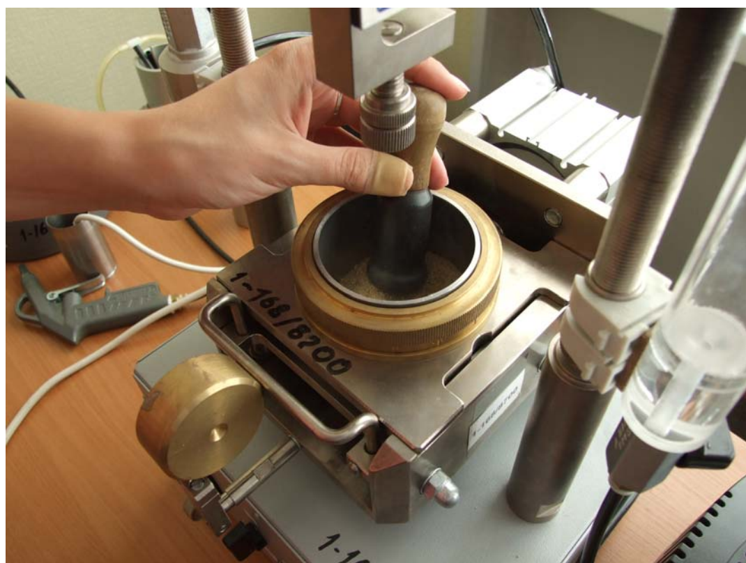
Рис. 11. Уплотняется грунт (послойно, до достижения заданной плотности)
