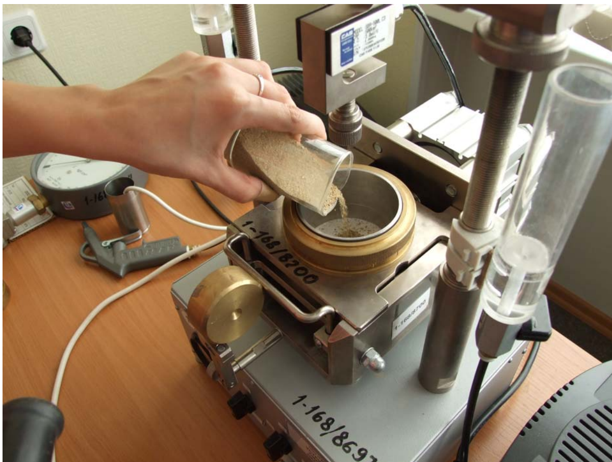
Рис. 10. Засыпается грунт (послойно)
