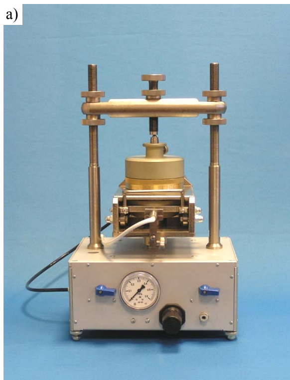
Рис. 12. Срезные приборы: а – статический способ приложения касательной нагрузки; б – кинематический способ приложения касательной нагрузки
