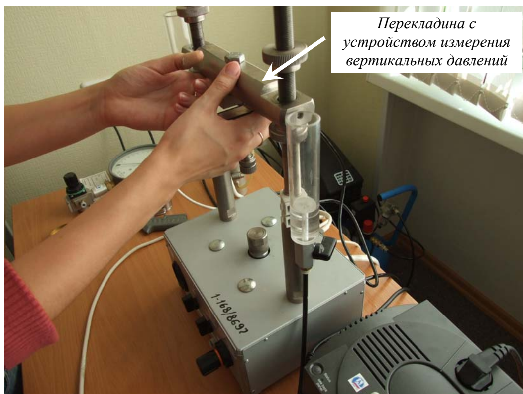
Рис. 1. Закрепляется датчик вертикального давления
