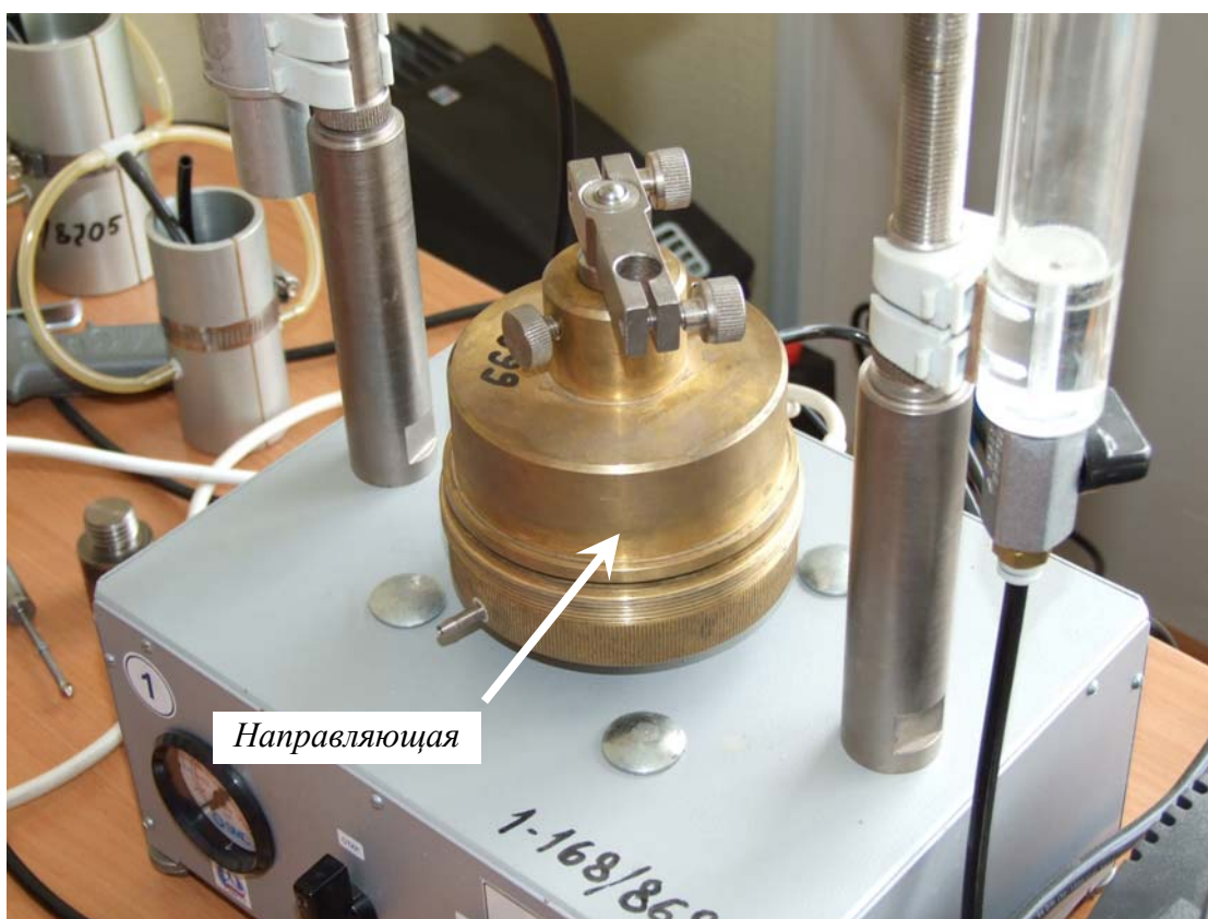
Рис. 4. Устанавливается верхняя часть одометра (направляющая) с поршнем для передачи вертикальной нагрузки
