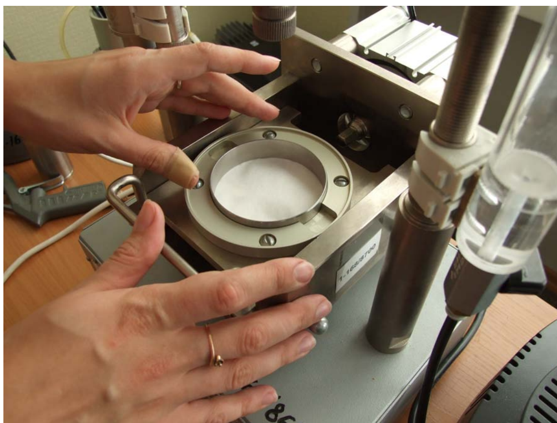
Рис. 7. Каретка задвигается в начальное положение
