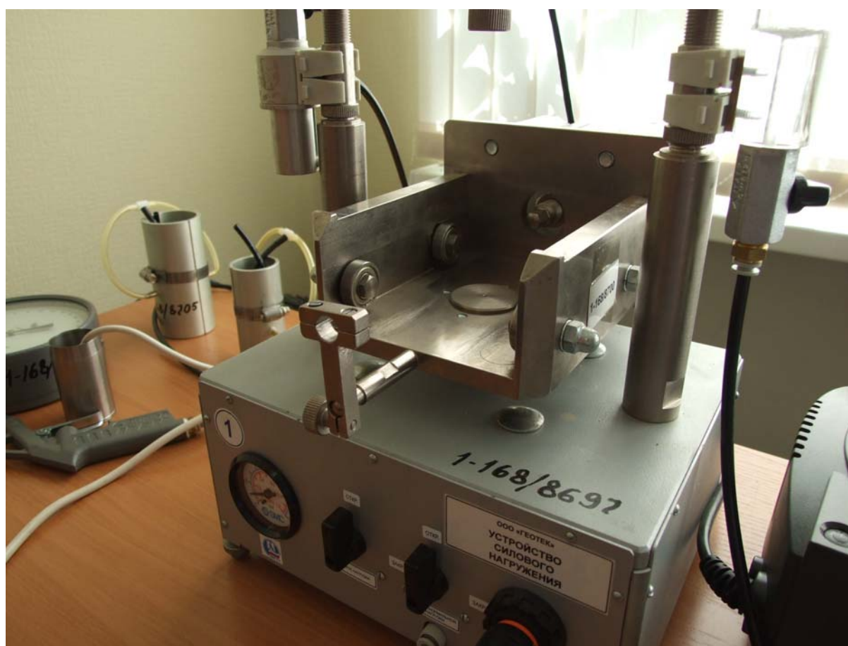
Рис. 3а. Установлена срезная коробка
