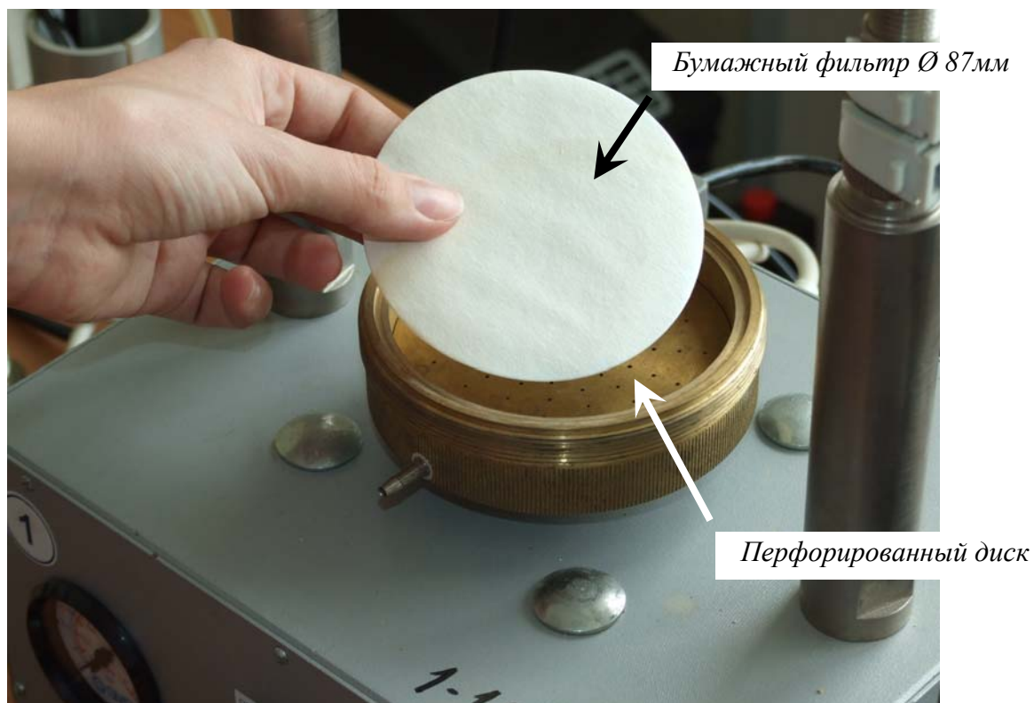
Рис. 2. В одометр вкладывается перфорированный диск и бумажный фильтр
